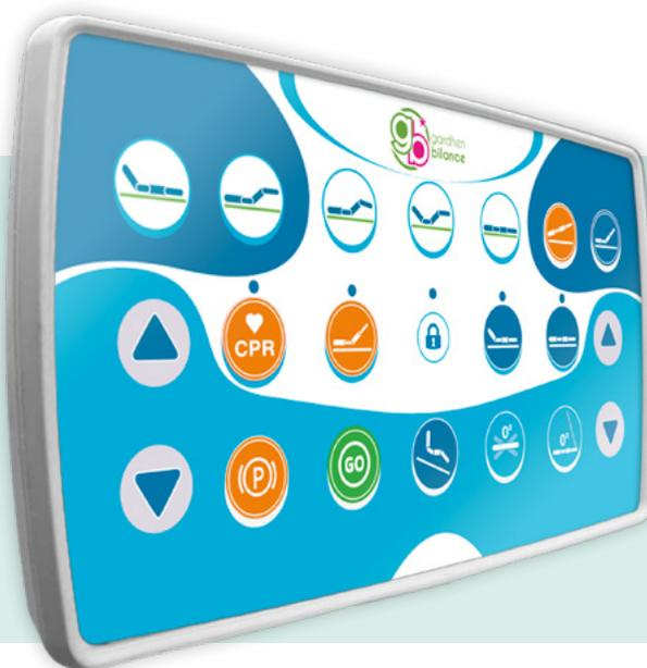
Per attuare le movimentazioni motorizzate tramite il pannello di controllo è necessario **premere contemporaneamente sia uno dei pulsanti freccia sù/freccia giù che il pulsante relativo alla sezione da movimentare**. La pressione combinata dei due tasti consentirà di movimentare il dispositivo.
